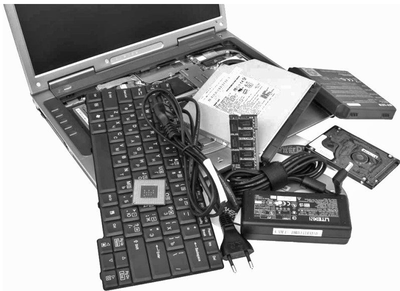
Рис. 2.11. Открутили клавиатуру и получили доступ к внутренностям ноутбука
